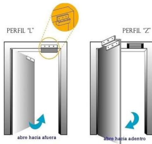
**Fig. 26 Instalación de las cerraduras electromagnéticas en las puertas.**
