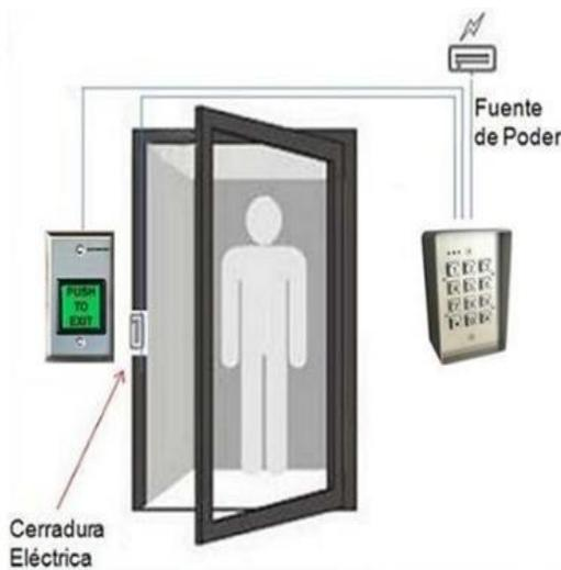
**Fig. 25 Componentes del Sistema De control de acceso en las puertas**
