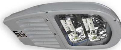
Luminaria de exteriores construida en aluminio, para ser colocada en postes de brazo  $\varnothing$  2" con disipador de calor incorporado para alargar la vida del LED, acabado al horno con reflector anodizado y conjunto óptico en led diseñado para mayor eficiencia fotométrica y difusor de vidrio templado.
