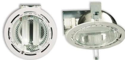
Lámpara embutida con cuerpo construido en hierro y aro de aluminio esmaltado al horno, con reflector de aluminio espejular y difusor lumínico de vidrio arenado. Utiliza 2 bombillos compactos fluorescentes no integrados de 26W 4000-4500°k en sócate E27.
