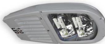
Luminaria de exteriores construida en aluminio, para ser colocada en postes de brazo  $\varnothing$  2" con disipador de calor incorporado para alargar la vida del LED, acabado al horno con reflector anodizado y conjunto óptico en led diseñado para mayor eficiencia fotométrica y difusor de vidrio templado.
