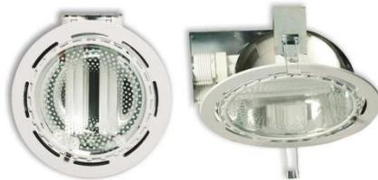
Lámpara embutida con cuerpo construido en hierro y aro de aluminio esmaltado al horno, con reflector de aluminio especular y difusor lumínico de vidrio arenado. Utiliza 2 bombillos compactos fluorescentes no integrados de 26W 4000 – 4500k en sócate E27.
