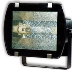
Reflector de cuerpo rectangular construido en aluminio acabado al horno con bastidor regulador de ángulo de enfoque. Posee reflector de aluminio texturizado y difusor lumínico de vidrio traslúcido templado. Utiliza bombillo metal halide de sócate Rx7s de 70W 3000°k.
